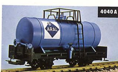
Kesselwagen Aral, LüP 300 mm Alle Kesselwagen können durch den Einfüllstutzen gefüllt und durch den Ablaßhahn entleert werden.
