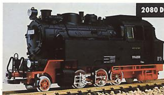
Dampflok C-gekuppelt der Harzquerbahn Nordhausen-Wernigerode, Achsfolge 1-C-1, Lok-Beleuchtung in Fahrtrichtung wechselnd, Führerstandbeleuchtung, Steckdose für Waggon-Innenbeleuchtung, LÜP 410 mm.
