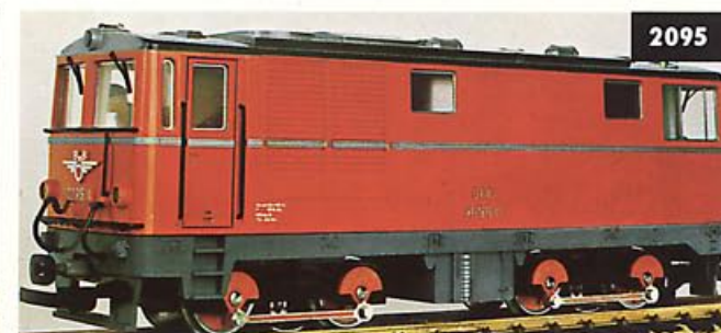
B'-B'-Diesellok der Österreichischen Bundesbahn, auf verschiedenen Strecken im Einsatz, u.a. Zell am See - Krimml. Mit 2 Motoren (besonders zugstark), Lokbeleuchtung in Fahrtrichtung wechselnd, Steckdose für WaggonInnenbeleuchtung, LÜP 460 mm.
